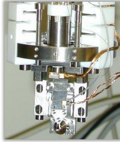
Resim 3.3. MFM cihazının uç yapısı [62]
