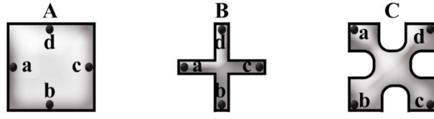
Şekil 3.9. Genel Van der Pauw yapıları: A) Kare B) Artı C) Yaprak
